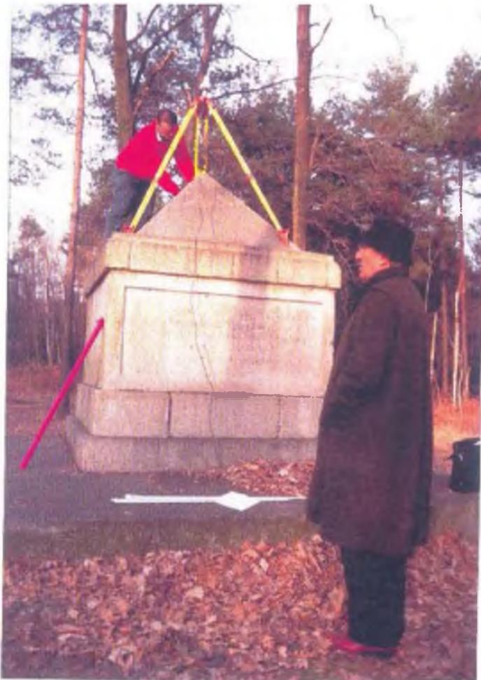
*Fig. 31 Le operazioni di misura satellitare all'estremo Nord della Base di Somma.*
